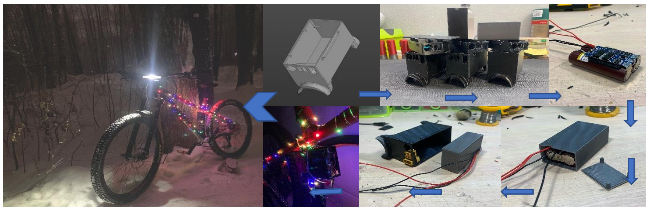
Рисунок 1 – обобщенный цикл от цифровой модели до готового устройства
