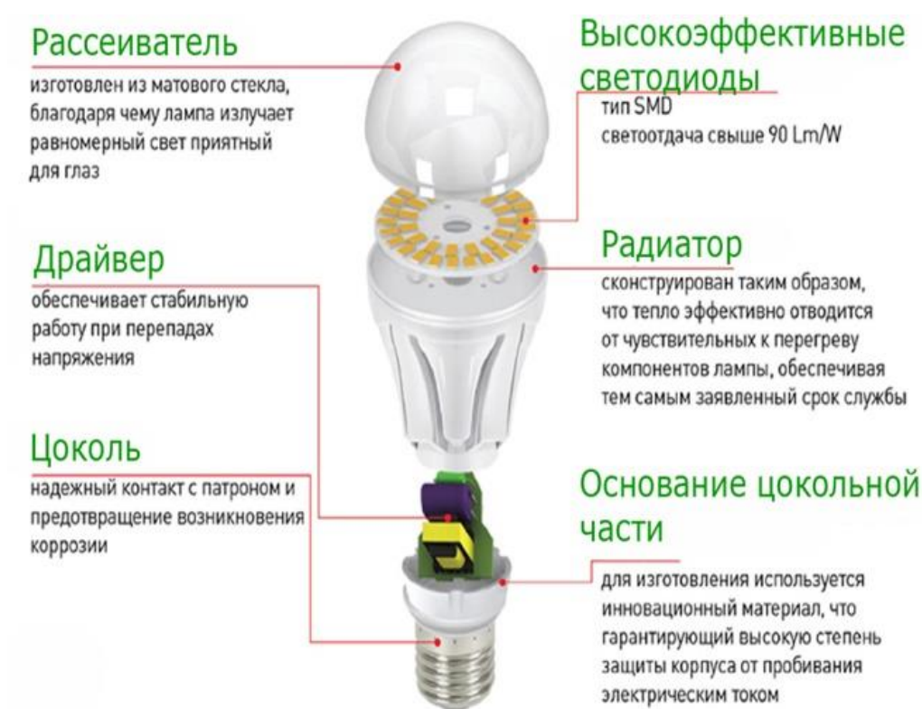
Рисунок 3-Строение светодиодной лампы.
