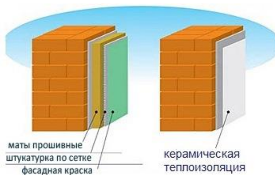
Рисунок 1 – Тепловая изоляция ограждающих конструкций
